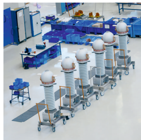
Элегазовые трансформаторы тока ТРГ-УЭТМ®-110
