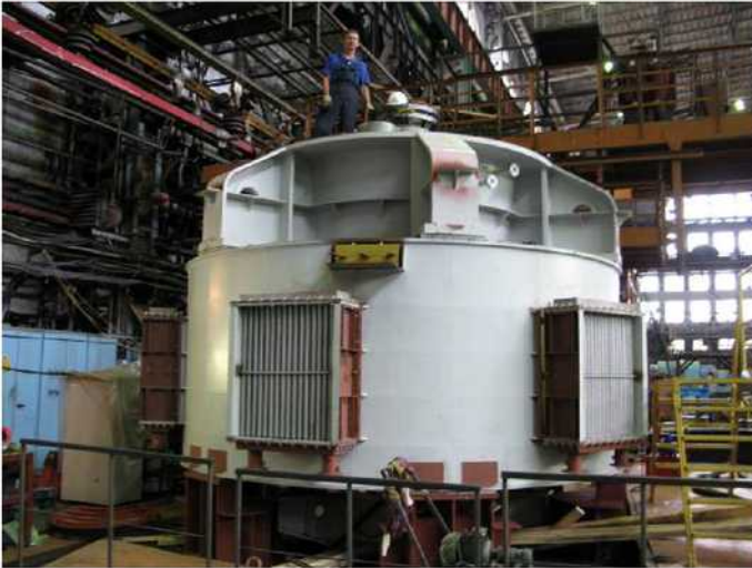
Вертикальный синхронный двигатель ВДСМ-375/105-24УХЛ4 12500 кВт, 10 кВ, 250 об/мин
