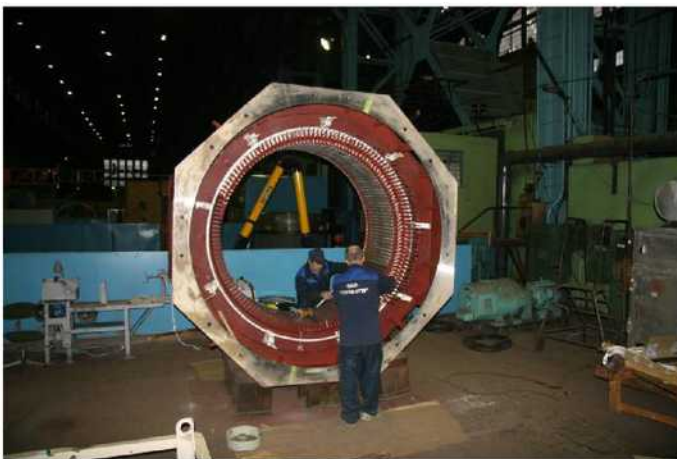
Статор двухскоростного асинхронного электродви- гателя 4АВД-215/59-16-20МУ3 1600/1000 кВт, 6 кВ, 375/300 об/мин
