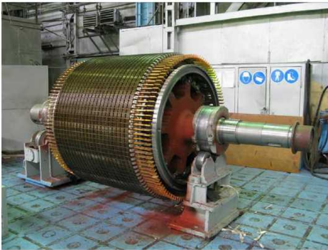
Ротор асинхронного электродвигателя ВА3-215/109-6-АМО5 8000 кВт, 6 кВ, 1000 об/мин
